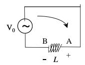
Aunque no haya resistencias, hay una caída de tensión entre A y B porque la corriente varía con el tiempo y se produce una fem inducida. ¿Por qué esos signos? Porque si i(t) aumenta, di/dt>0 y la fem inducida es tal que genera una corriente en sentido contrario, i.e. A está a mayor voltaje que B. En consecuencia
